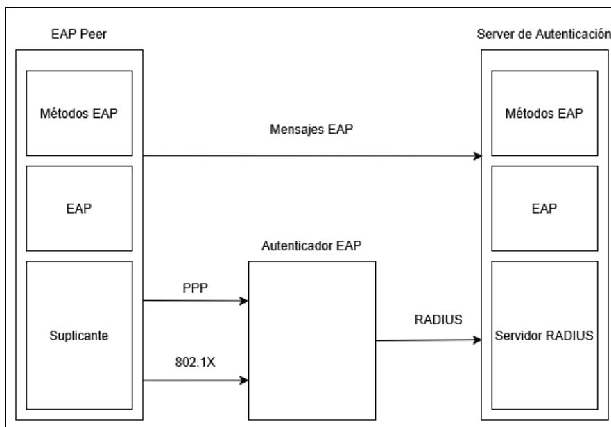
EAP define formatos genéricos de autenticación: Request, Response, Success, Failure. El tipo de autenticación EAP especifica los mecanismos de autenticación seleccionados y el tipo de credenciales.
