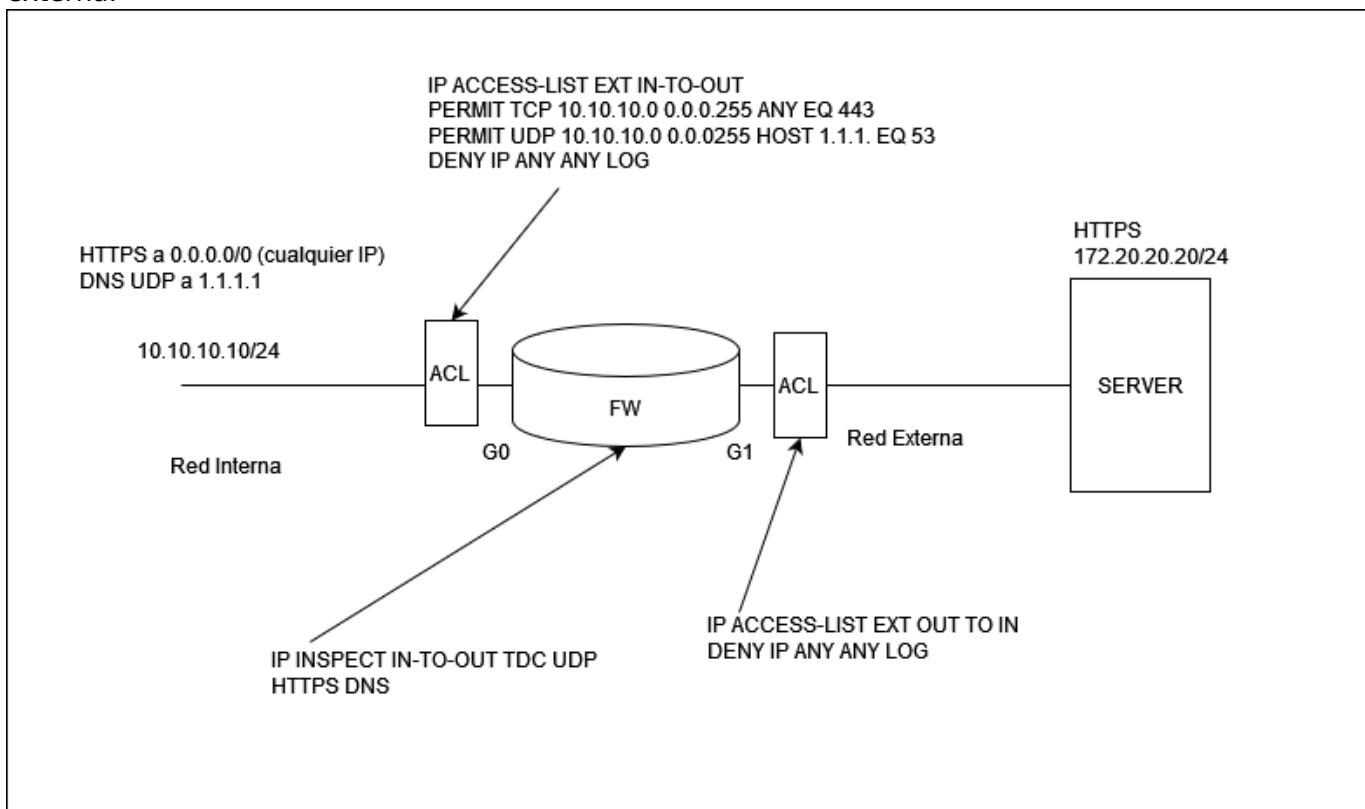
Se establecen dos ACL, una de entrada y otra de salida que filtren el tráfico de entrada y salida, mientras que el firewall inspecciona el tráfico TCP y UDP con peticiones HTTPS y DNS.
