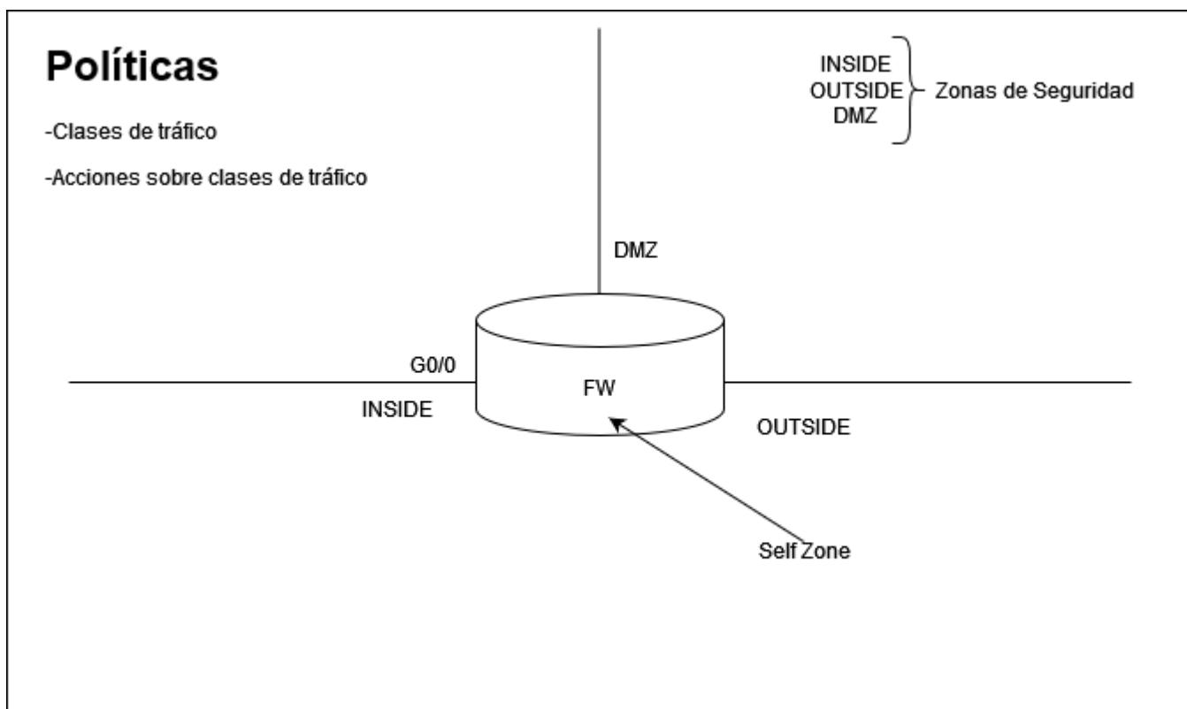
Por defecto, las interfaces pertenecen a la zona por defecto, excepto el que va dirigido a las interfaces del router, que se clasifican como self-zone. Las interfaces que pertenecen a la misma zona de seguridad pueden intercambiar tráfico mientras las que no, no pueden a menos que se implemente en una política de tráfico.
