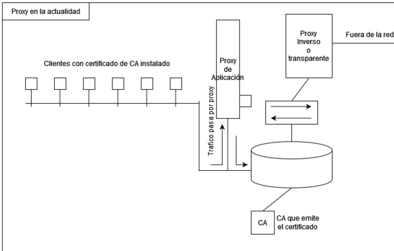
Con una topología como esta se puede hacer que todo el tráfico de red salga por el proxy con una ACL. El proxy puede comprobar si hay algún tipo de malware o si el tráfico que pasa por el está permitido y en función de que sea bloquearlo o dejarlo pasar. Hay varios tipos de proxy:
